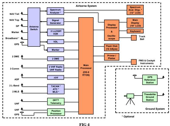
BLOCK DIGRAM OF NORMARC FLIGHT INSPECTION SYSTEM - NFIS
